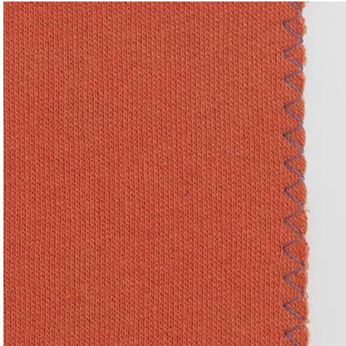
Der Zickzack Nr. 2 eignet sich für alle Stoffe. Er kann aber auch bei elastischen Nähten sowie auch für dekorative Arbeiten genutzt werden. Für feine Stoffe sollte Stopffaden verwendet werden. Für die Raupennaht empfiehlt es sich, einen dichten, kurzen Zickzack mit einer Stichtlänge von 0.5 – 0.7 mm einzustellen. Die Raupennaht kann für Applikationen und für das Sticken genutzt werden.
