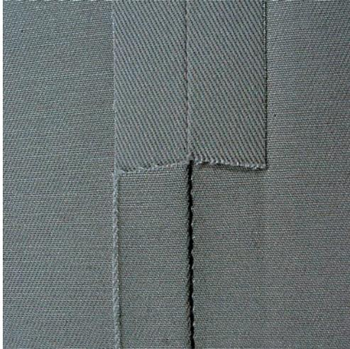
Der Dreifach-Geradstich ist besonders für strapazierfähige Nähte und für harte und dichte Stoffe wie Jeansstoff und Cordsamt geeignet. Bei harten oder sehr dicht gewobenen Stoffen empfiehlt es sich, den Jeansfuss Nr. 8 (Sonderzubehör) zu montieren. Dies erleichtert das Nähen von Jeansstoff oder Segeltuch. Für das dekorative Absteppen kann zusätzlich die Stichlänge vergrößert werden.
