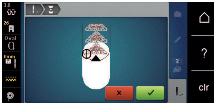
> Stickrahmen entfernen und Stoff so umspannen, dass sich die ausgestickten Referenzpunkte im oberen Stickbereich des Stickrahmens befinden und die Referenzpunkte mindestens 3 cm (1.18 inch) vom oberen Rand des Stickrahmens entfernt liegen.
