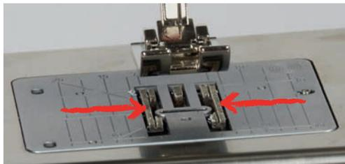
Bei sehr kurzer Stichlänge sind die Schritte sehr klein. Zum Beispiel bei Knopflöchern und Raupennähten. Der Stoff gleitet nur langsam unter dem Nähfuss weg, auch bei maximaler Geschwindigkeit.
